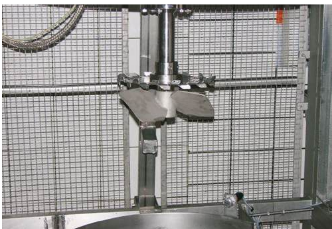
Produkcja serów Mieszadło spożywcze TURBO-MIXER do homogenizacji sera
