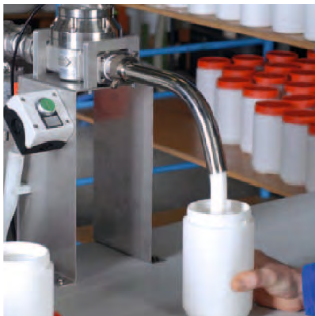
VISCOFLUX mobile – ciągła praca (przykład: wazelina).
