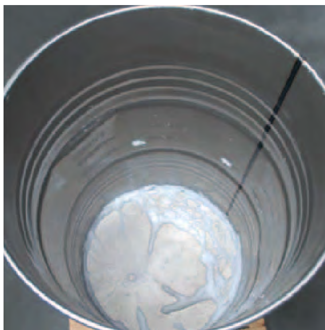
VISCOFLUX mobile – resztowe ilości cieczy poniżej 1% (w beczkach bez inliner) – pomimo wgniecień transportowych.
