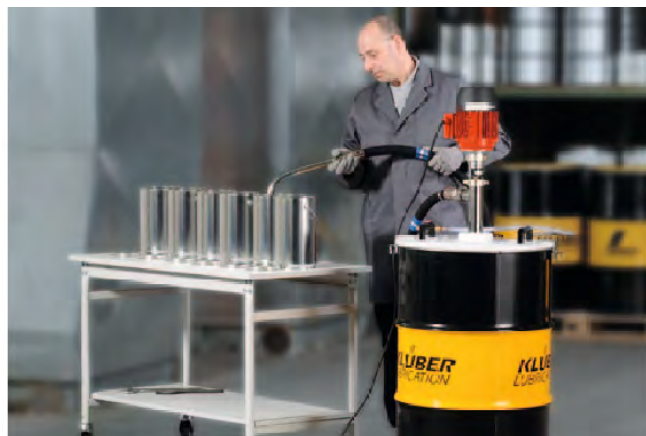
Opróżnianie wysokotemperaturowego smaru.
