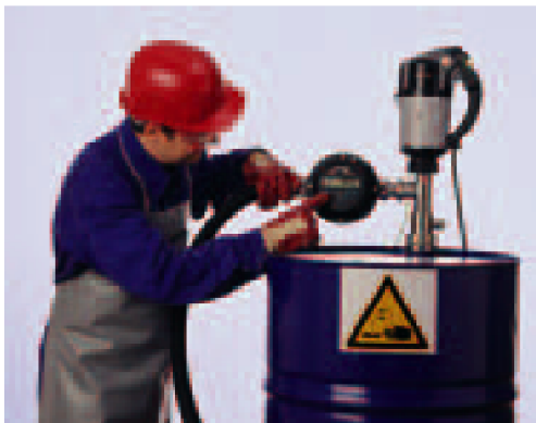
Zastosowanie przenośne: FLUX FMC 100 z pompą beczkową
